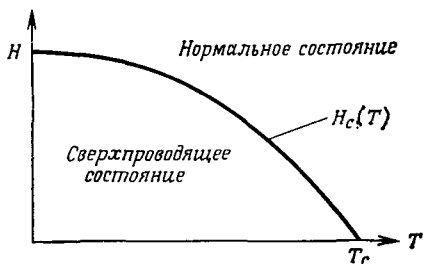
Фиг. 34.3. Фазовая граница на плоскости H - T между сверхпроводящим и нормальным состояниями сверхпроводника первого рода.
