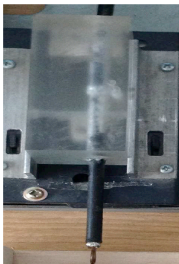
Рисунок 37 – Внешний вид приемной антенны: коаксиальный кабель, внутренний провод которого запаян на внешнюю оплетку, образует кольцо с радиусом 3 мм.
