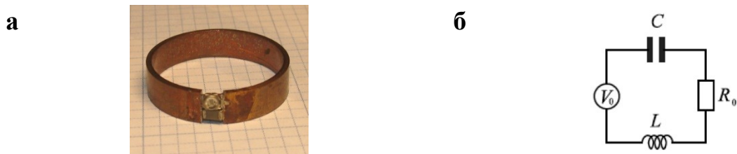
Рисунок 1 – (а) Пример метаатома в МГц диапазоне – расщепленный кольцевой резонатор с впаянной емкостью. Внешний диаметр кольца – 23 мм, размер щели – 2 мм, впаянная емкость C=330 пФ, резонансная частота \omega_0=50.22 МГц, добротность Q=160 . (б) Эквивалентный LCR -контур.
