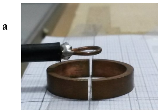
Рисунок 11 – (а) Фотография исследуемого образца. Внешний диаметр 23.9 мм, высота 5 мм, толщина стенок 2 мм, размер щели 1 мм. (б) Экспериментальная зависимость сигнала элемента от частоты. Резонансная частота – 2.56\pm 0.02 ГГц, добротность Q=18 .
