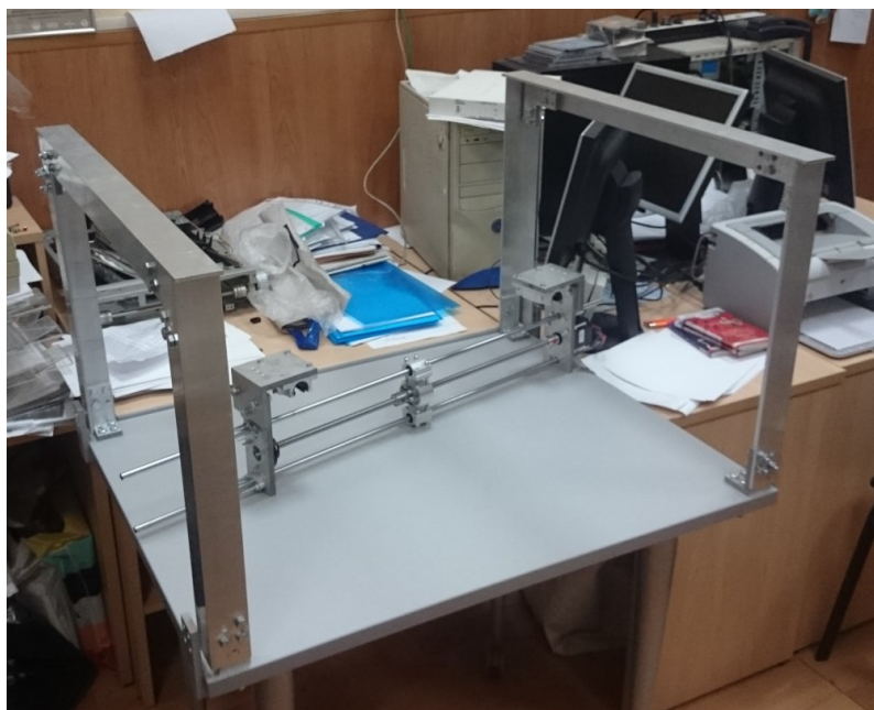
Рисунок 13 - Две П-образные рамы, закрепленные на столе, и частично собранная верхняя каретка на столе в центре.
