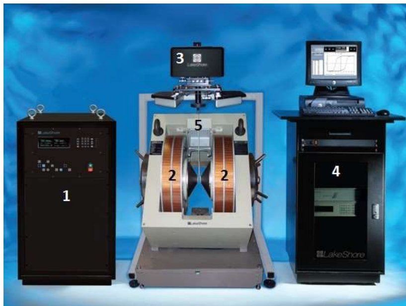
Рисунок 20. Внешний вид вибрационного магнитометра Lakeshore 7400 . Цифрами указаны: 1 — источник питания с водяным охлаждением, 2 — полюса электромагнита с водяным охлаждением, 3 — генератор механических колебаний, 4 — блок управления с ПК, 5 — кварцевый шток для крепления образца.
