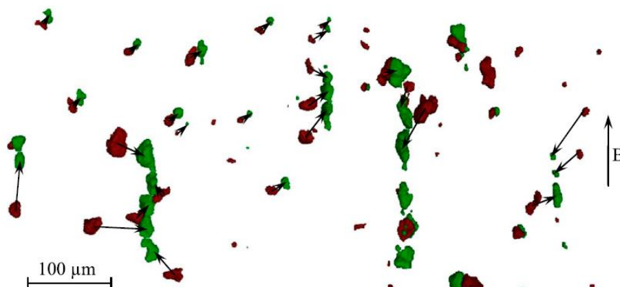
Рисунок 2. Смещение частиц под действием магнитного поля. Результаты микротомографии [5].
