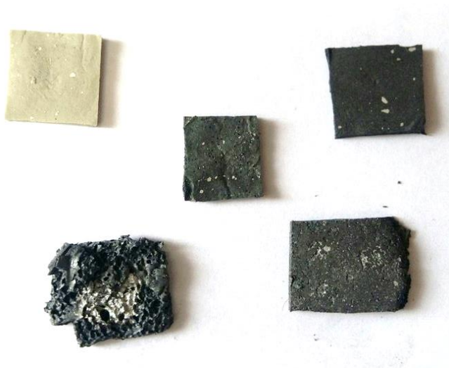
Рисунок 38. Изготовленные образцы МРЭ с частицами железа и цирконата-титаната свинца
