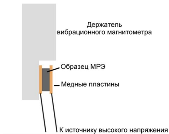
Рисунок 35. Конфигурация измерений магнитных свойств в электрическом поле
