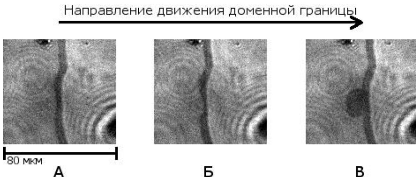
Рисунок 10. Наблюдаемые проявления эффекта взаимодействия динамической доменной границы и импульса накачки. Скорость движения ДГ 400 м/с,  $H_{pl} = 0,7 \text{ кЭ}$ ,  $W_{\text{pump}} = 1.3 \text{ мВт}$ .
