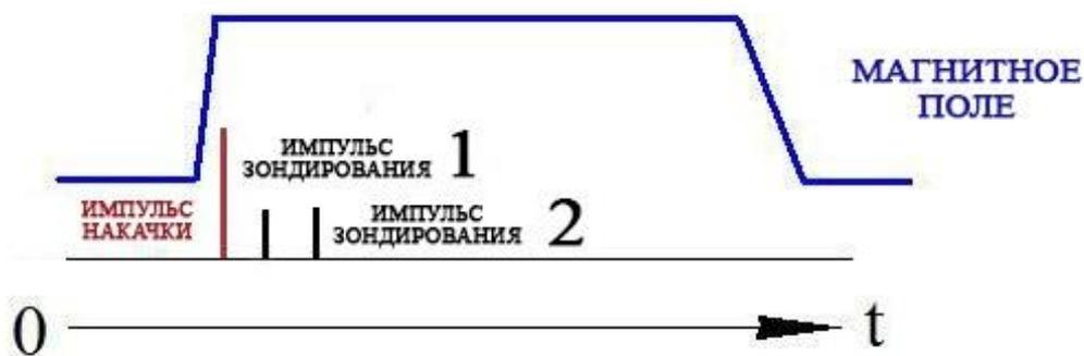
Рисунок 6. Взаимное расположение импульсов света и магнитного поля.
