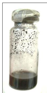
Рис. 19. Фотография готовой феррожидкости на основе глицерина с частицами феррита кобальта
