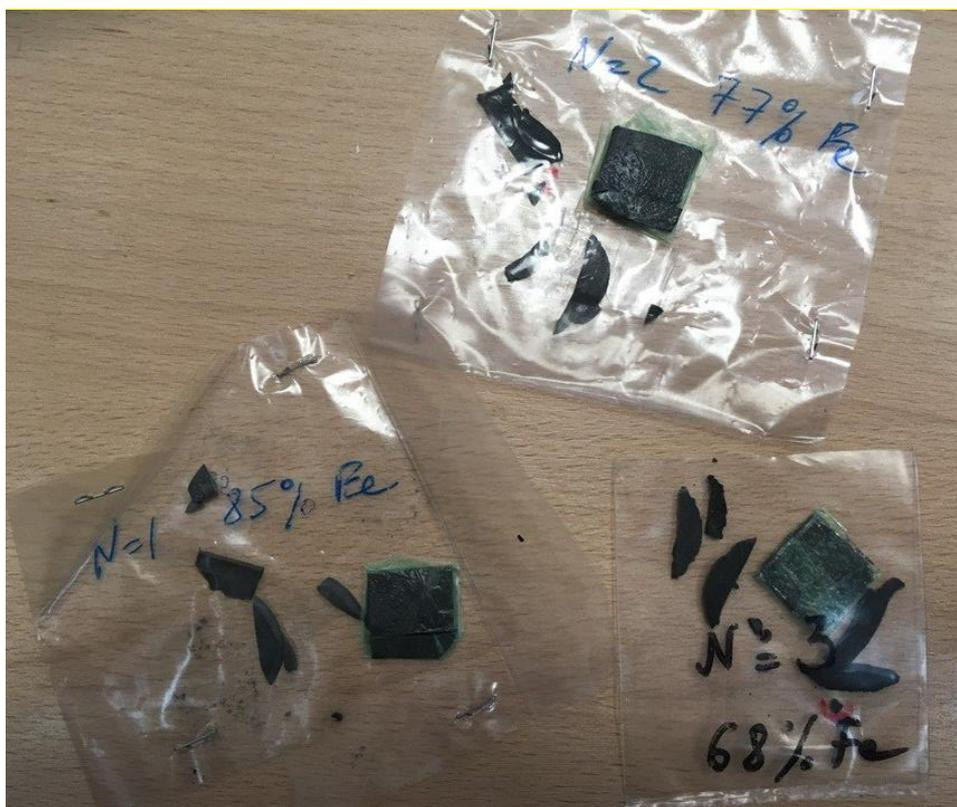
Рис.23 Образцы МРЭ с частицами Fe 68%, Fe 77% и Fe 85%.
