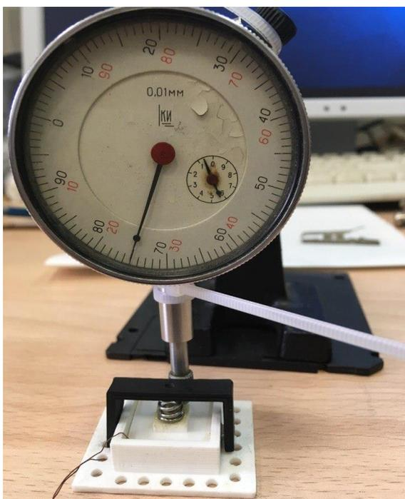
Рис.22а. Положение верхней обкладки плоского конденсатора с МРЭ в качестве диэлектрика без приложенного давления
