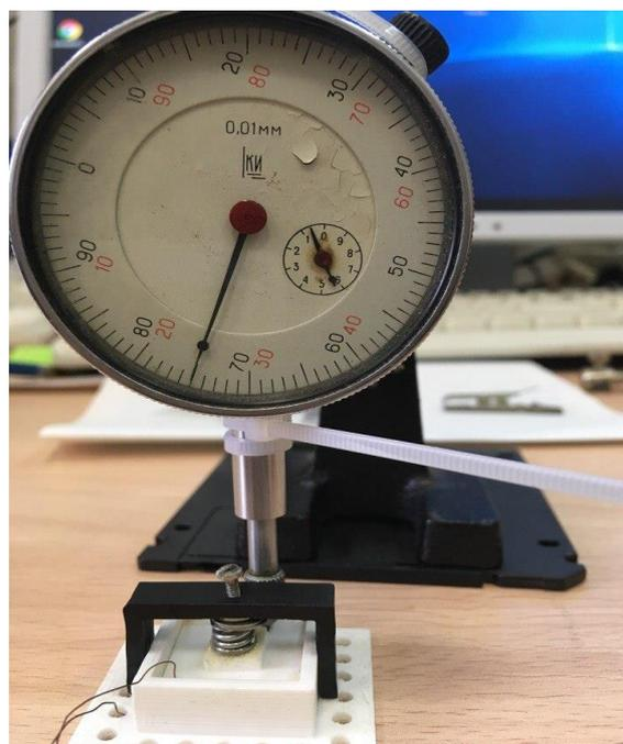
Рис.22б. Положение верхней обкладки плоского конденсатора с МРЭ в качестве диэлектрика при максимальном прикладываемом давлении
