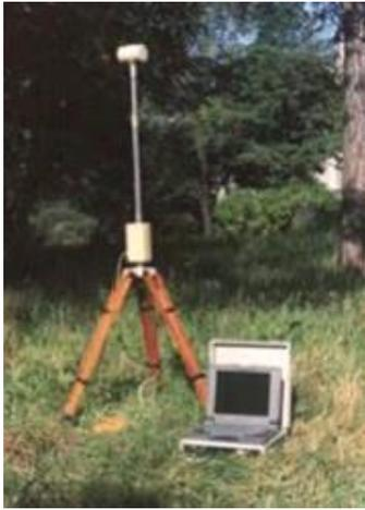
Прибор предназначен для геологоразведочных наземных работ, магнитных обсерваторий и мер индукции слабого магнитного поля 1-го разряда. Технические параметры прибора соответствуют и превосходят по ряду параметров иностранные аналоги (диапазон измерений 20000 – 100000 нТл, абсолютная погрешность  $\pm 0,5$  нТл, чувствительность
