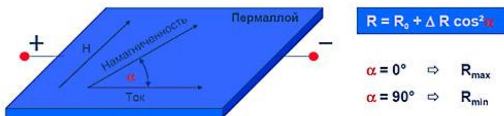
Рис. 13 Общий вид магниторезистивного датчика
