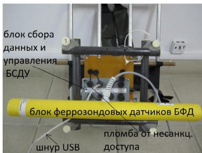
Рис. 12 Общий вид блока феррозондовых датчиков с блоком управления
