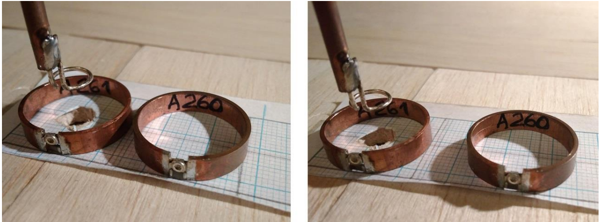
Рисунок 19 – Измерение коэффициента взаимодействия мета-атомов в планарной конфигурации при различных расстояниях между ними с использованием векторного анализатора цепей Agilent FieldFox N9923A. Резонансные элементы закреплены на подложке из бальсы, подвижная приемная антенна находится над центром первого элемента, под которым внутри подложки закреплена излучающая антенна. \omega_0=50.83 МГц.
