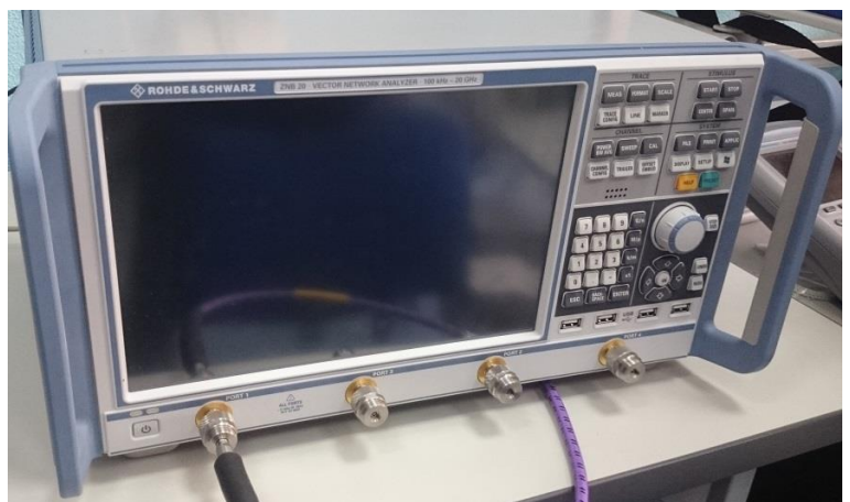
Рисунок 18 – Внешний вид векторных анализаторов цепей: Agilent FieldFox N9923A (слева), Rohde&Schwarz ZNB20 (справа).
