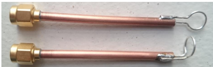
Рисунок 21 - Возбуждающая (сверху) и приемная (снизу) антенны для локального возбуждения мета-атомов.
