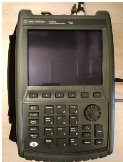
Рисунок 18 – Внешний вид векторных анализаторов цепей: Agilent FieldFox N9923A (слева), Rohde&Schwarz ZNB20 (справа).
