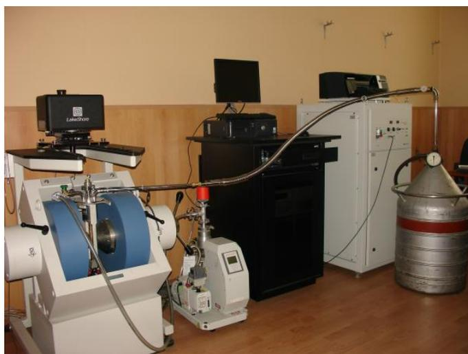
Рисунок 26. Вибрационный магнетометр.
