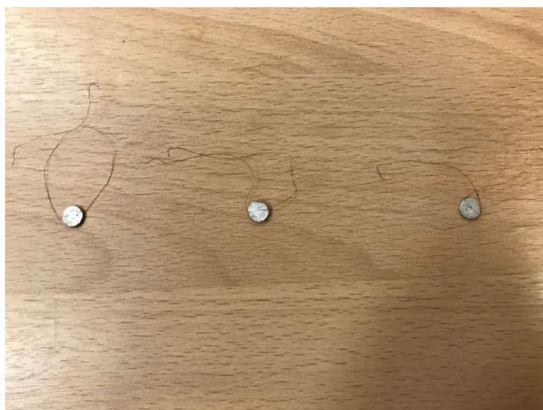
**Рис. 9.** Фотография образцов для измерений магнитодиэлектрического эффекта.
