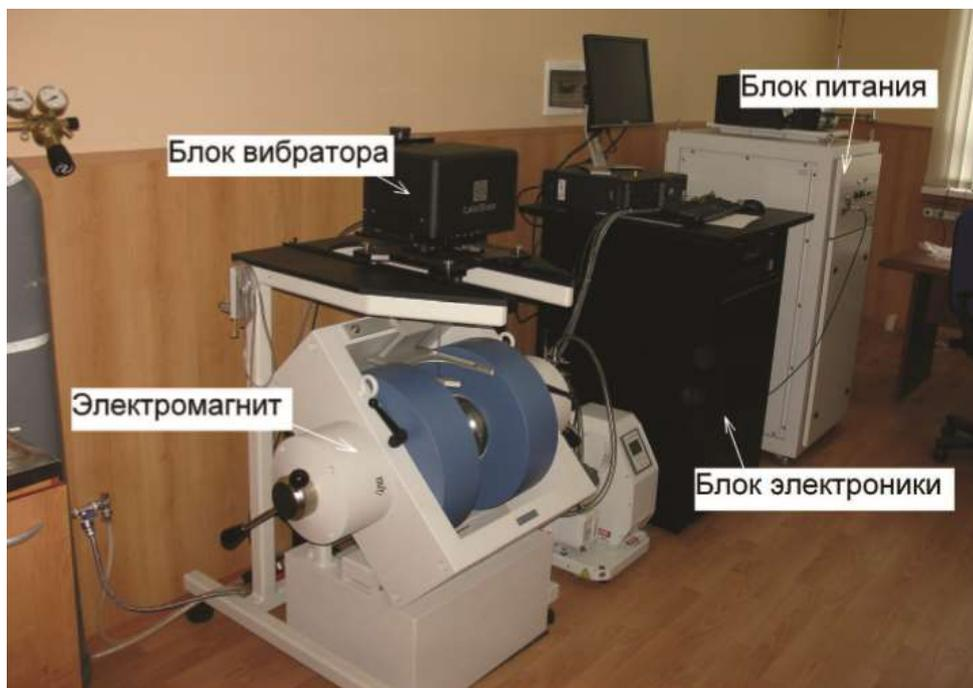
Рис. 10. Общий вид вибрационного магнитометра LakeShore 7400 [21].
