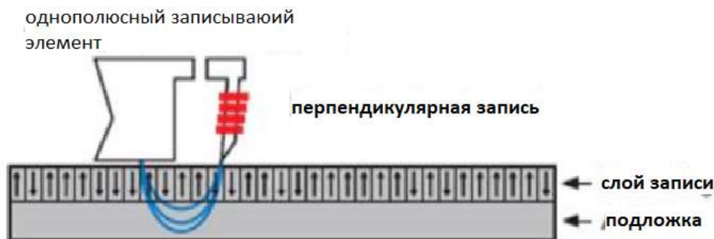
Рисунок 3. Принцип перпендикулярной записи информации.
