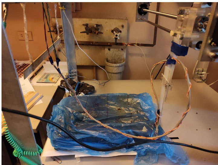
Рисунок 9. Фото установки для измерения распределения индукции магнитного поля.
