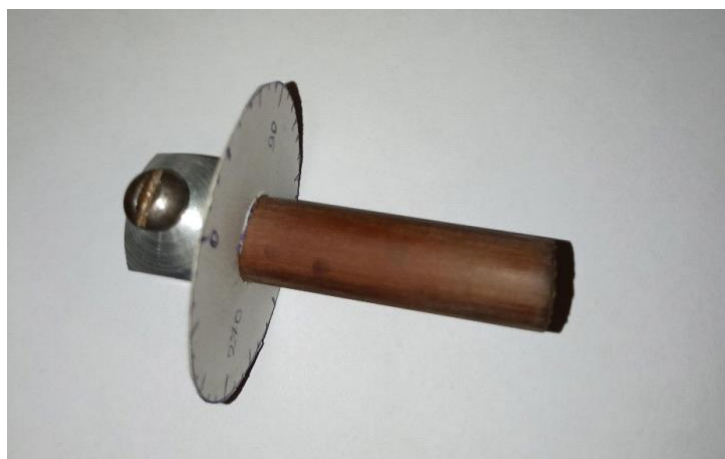
Рисунок 6. Элемент крепления образца.
