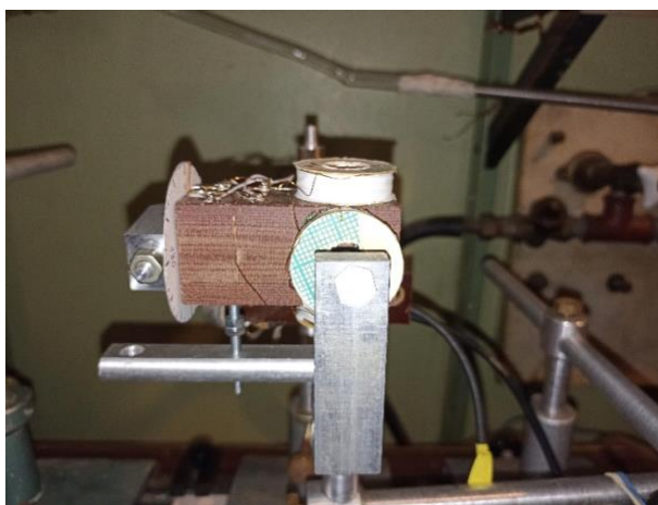
Рисунок 5. Система крепления образца.
