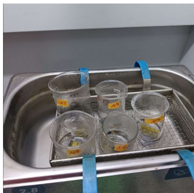
Рис.4. Растворение ростовой полимерной матрицы
