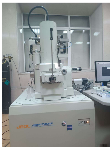
Рис.6. Растровый электронный микроскоп JSM–7401F (JEOL)
