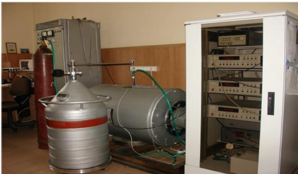
Рис. 15. Фотография экспериментального комплекса для измерения магнитотранспортных свойств материалов.
