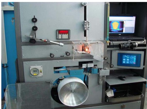
*Рис. 1.4. Установка для изготовления быстрозакаленных «толстых» микропроводов с помощью модифицированного метода Улитовского – Тейлора.*
