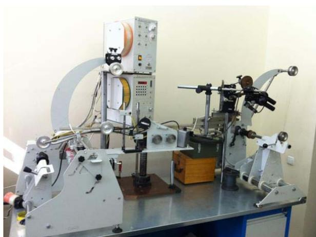
*Рис. 1.5. Установка по удалению стеклянной оболочки с микропровода.*
